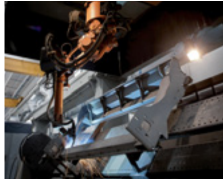
Quatre îlots de soudure robotisée
