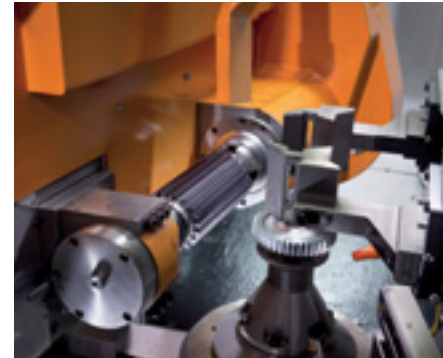
Machine de taillage robotisée, production d'engrenages
