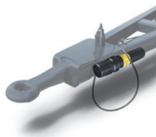
**SEALED PLASTIC PIPE WITH SPARE PARTS MANUAL / ГЕРМЕТИЧНАЯ ПЛАСТИКОВАЯ ТРУБКА С ИНСТРУКЦИЕЙ ПО ЭКСПЛУАТАЦИИ**
